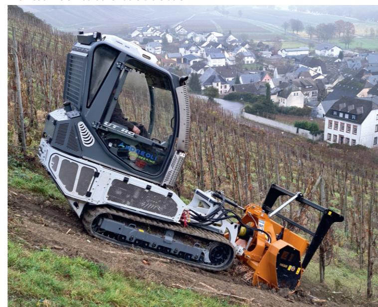
» Una caratteristica fondamentale di UT 110 è la versatilità di guida: con una sola mano l'operatore controlla l'avanzamento della macchina e sul secondo joystick sono raggruppati i comandi del sollevatore e delle prese idrauliche ausiliarie. La macchina può ruotare sul proprio asse verticale di 360°.
