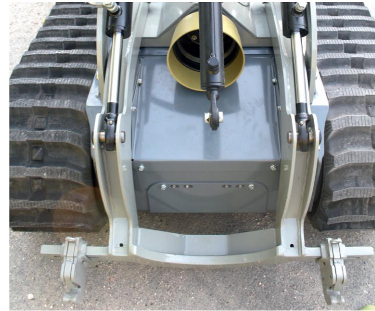
» Il sollevatore a tre punti è dotato di serie di barra porta ganci con posizione flottante, che permette di svincolare il movimento dell'attrezzatura frontale dall'assetto della trattice consentendone un perfetto e costante livellamento al terreno.
