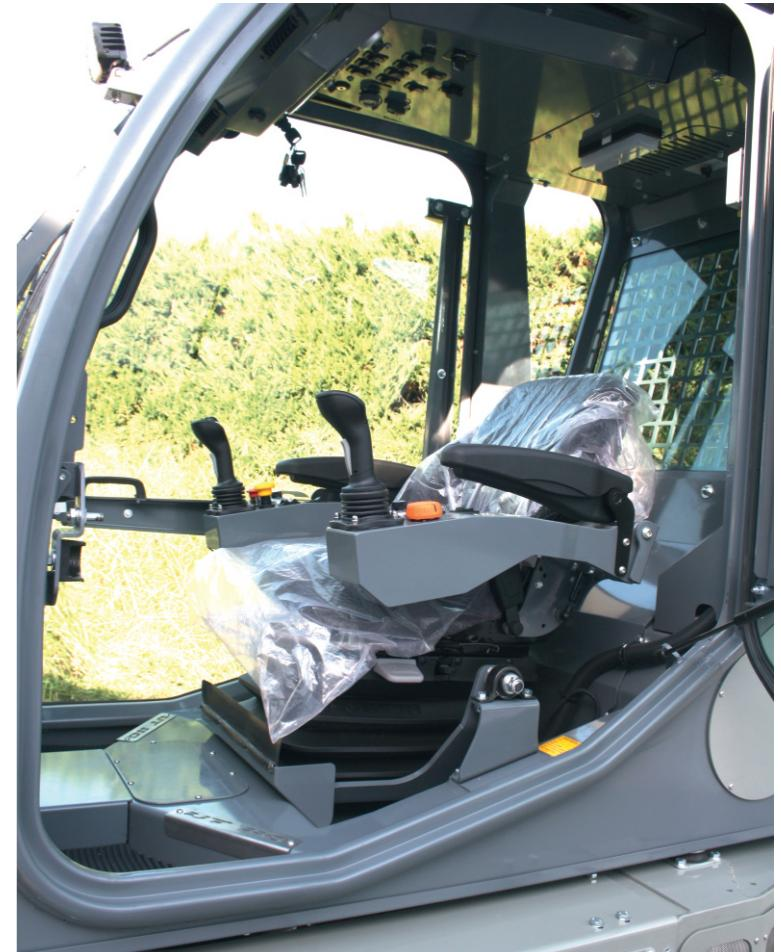
» **UT 110** è dotato di cabina di guida insonorizzata e pressurizzata, con filtro aria a carboni attivi, aria condizionata e riscaldamento. Il sedile di guida con sospensione pneumatica a regolazione automatica, può essere inclinato per permettere all'operatore una posizione di guida confortevole anche sulle forti pendenze.
