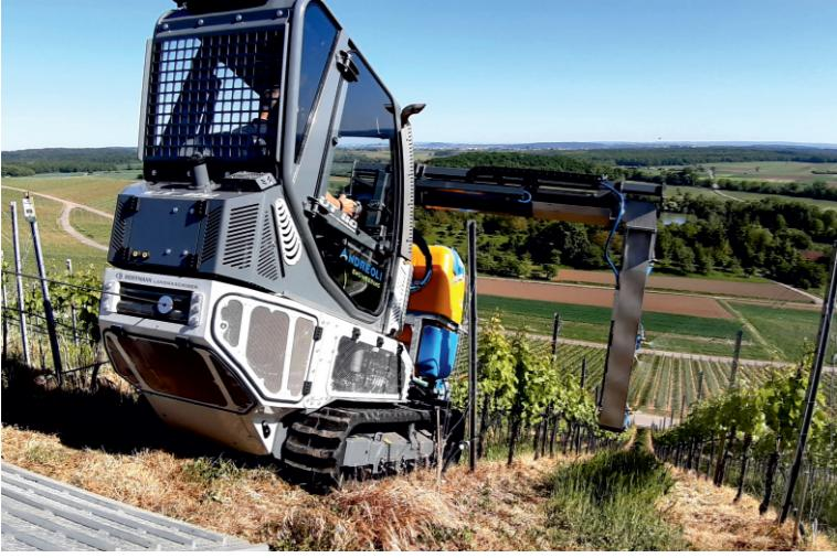
» La geometria della macchina consente di installare diverse attrezzature come atomizzatore, vendemmietrice, solforatrice, spargi concime, escavatore, cimatrice, cassone per trasporto cose, ecc. Tutte le attrezzature gravano direttamente sui cingoli, in modo da contenere la lunghezza totale del sistema unità motrice - attrezzatura, con importanti benefici in termini di maneggevolezza e stabilità.
