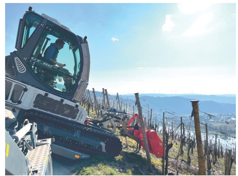
» La macchina può essere allestita con argano anteriore a controllo elettronico, che consente di operare in massima sicurezza su pendenze longitudinali estreme, nel più assoluto rispetto dell'integrità del suolo.
