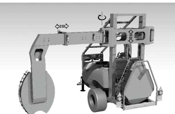
» La struttura scavallante di supporto dei convogliatori laterali è interamente realizzata in acciaio alto resistenziale AHSS (Advanced High Strength Steel).
