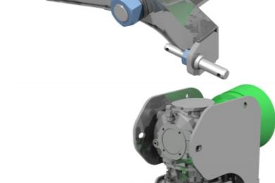
» Timone sterzante **SUPERTURN** omologato con doppia coppia conica e bloccaggio idraulico. Consente l'allineamento costante al trattore e l'inserimento permanente della PTO.
