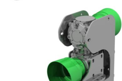
» Timone sterzante **SUPERTURN** con doppia coppia conica con aggancio ai bracci del sollevatore. Consente l'allineamento costante al trattore e l'inserimento permanente della PTO.
