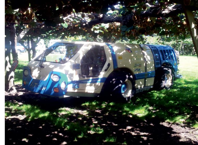
» Il convogliatore VAC 896 KIWI aumenta l'efficacia del trattamento in tutte le condizioni di vegetazione. Aspirazione frontale. Doppia uscita d'aria. Sistema di correzione e guida del flusso d'aria che copre uniformemente tutte le parti della vegetazione. Le doppie raggere di getti con diversa inclinazione garantiscono un trattamento incrociato con altissima efficacia di copertura.
