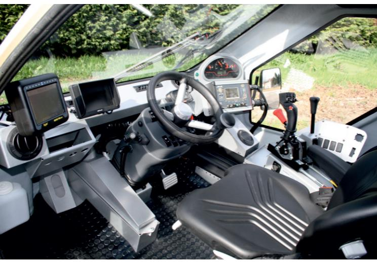
» Cabina pressurizzata, livello di protezione Categoria 4. Filtro aria cabina Categoria 4. Aria condizionata, riscaldamento. Climatizzatore automatico. Joystick di comando con interruttori di controllo per gli ugelli. Regolazione della pressione tramite comando elettrico. Display digitale livello cisterna e pressione di lavoro. Computer automatico per il controllo delle dosi. Sistema GPS di guida con interfaccia computer. Display 7" a colori con telecamere IR.
