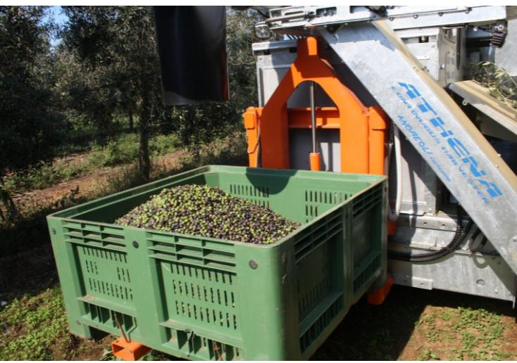
» **ATHENA** consente un'efficienza di raccolta superiore al 95% anche con elevate velocità di raccolta, oltre gli 1,5 km/h, su olivi alti fino a 5 metri. Grazie al sistema di raccolta brevettato, l'elevata velocità di lavoro si coniuga con l'assoluto rispetto dell'integrità delle olive raccolte, consentendo di operare tempestivamente nel momento ottimale di maturazione ed incrementando il livello qualitativo dell'olio estratto.
