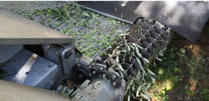
» **ATHENA** può essere allestita con l'apparato di raccolta sul lato destro o sinistro per poter lavorare sui due lati del filare in modo speculare ed aumentare la produttività.
